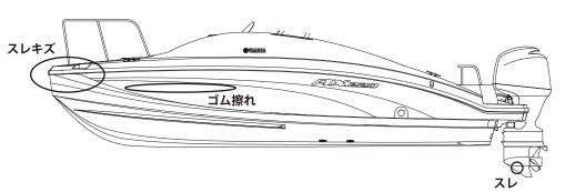
破損 貸出艇チェックリスト No. 使用前点検 使用後点検 安全備品は完備しているか。 1 2 船体各部に損傷はないか。 3 船内に水はたまっていないか。 ドレンプラグは確実に締め付けられているか。 4 5 バッテリーの液面はレベル内にあるか。 バッテリー端子は確実に締め付けられているか。 7 エンジンオイルは適量・適質か。 燃料ホースのジョイントは燃料タンクに確実に取り付けてあるか。 9 燃料フィルターに水・ゴミなどがたまっていないか。 10 燃料タンク、燃料配管、各接続部からの燃料漏れはないか。 11 燃料は満タンに入っているか。 ステアリング・ヘルムポンプのオイル漏れが無いか。 ガタツキは無いか。 13 │装備品の作動は正常か。
